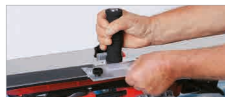
Einstellen des Abstandes zur Seitenkante / Adjusting the distance to the steel edge / Réglez la distance par rapport à la carre / Impostazione della distanza dal lamina laterale
