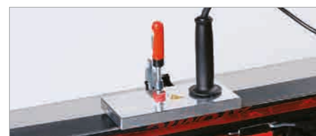
Vorwärmen des Belages Pre-heating the base Préchauffage du revêtement Pre-riscaldamento della base
